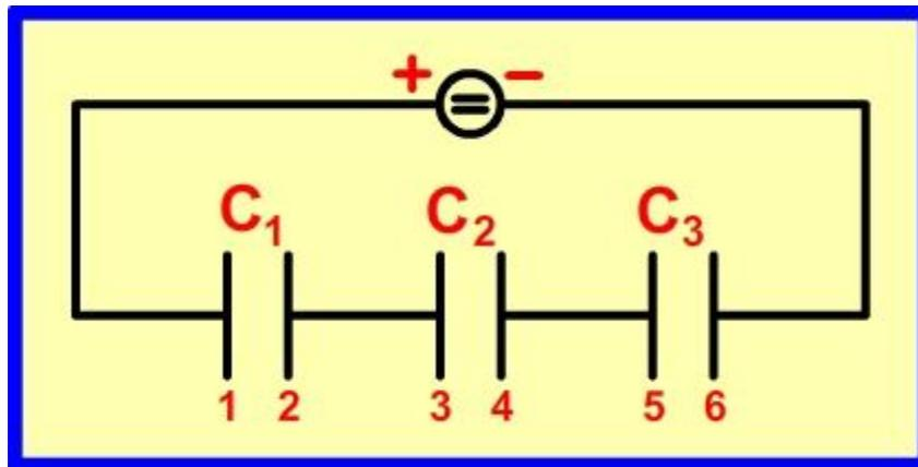
Die drei Kondensatoren mit den Kapazitäten  $C_1$ ,  $C_2$  und  $C_3$  sind in Serie geschaltet. Die einzelnen Kondensatorplatten wurden zur leichteren textlichen Begründung durchnummeriert.
