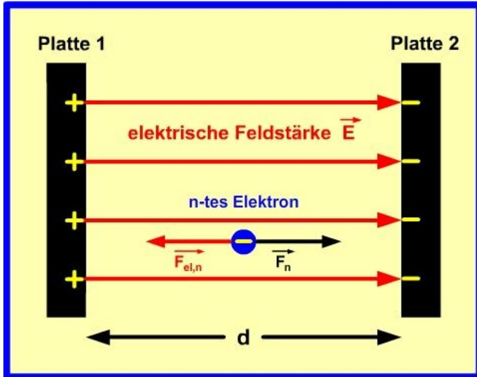
Normalerweise wird ein Kondensator aufgeladen, indem die Stromquelle von der Platte 1 Elektronen über die Verbindungskabel zur Platte 2 transportiert. Die Platte 1 wird dadurch positiv geladen (Elektronenmangel); die Platte 2 wird negativ geladen (Elektronenüberschuss).
